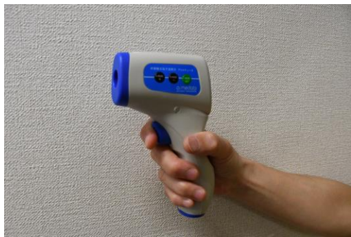
③ 相手のおでこに向けてトリガーを押すだけ！ (測定距離は1～3 cm)
